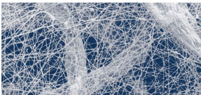
Medio de Fibra Fina (600px) – La tecnología de carga superficial de fibra fina está disponible en todos los cartuchos de filtro Ultra-Web® y Fibra-Web®.
