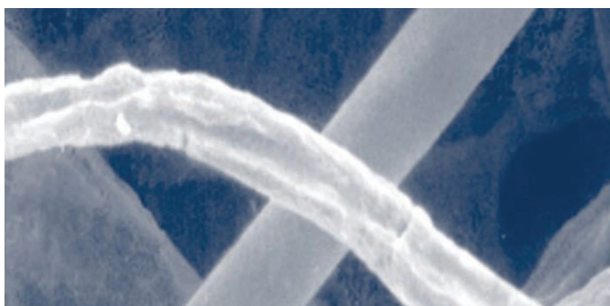
Masowo stosowane materiały filtrujące (600px) – Przerwy między włóknami w standardowych materiałach wynoszą 60 µm, dzięki czemu pył zostaje głęboko osadzony.
