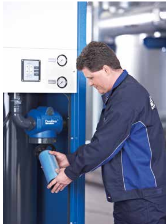
La carcasa del filtro Ultra-Filter es fácil de abrir para cambiar el elemento filtrante.
